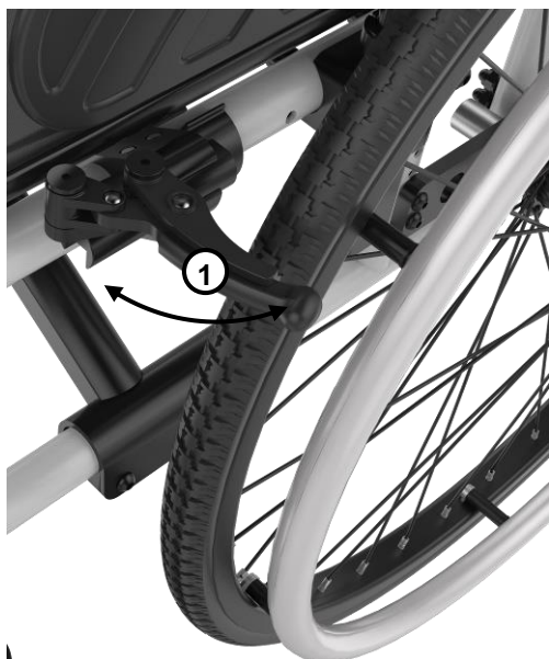
Frein activé (le fauteuil roulant ne roule pas)
